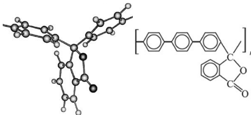
Рис.1. Структура полимера с широкой запрещенной зоной – полидифенилфталида, вид мономерного звена. Большие шарики обозначают – атомы углерода, темно серые шарики обозначают – атомы кислорода, малые серые шарики - атомы водорода.
